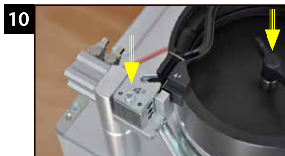
Replace the feeder bowl and the plate with the 4 mm 2 ones. Sostituire il vaso di alimentazione e la piastrina con quelli 4 mm 2 .
